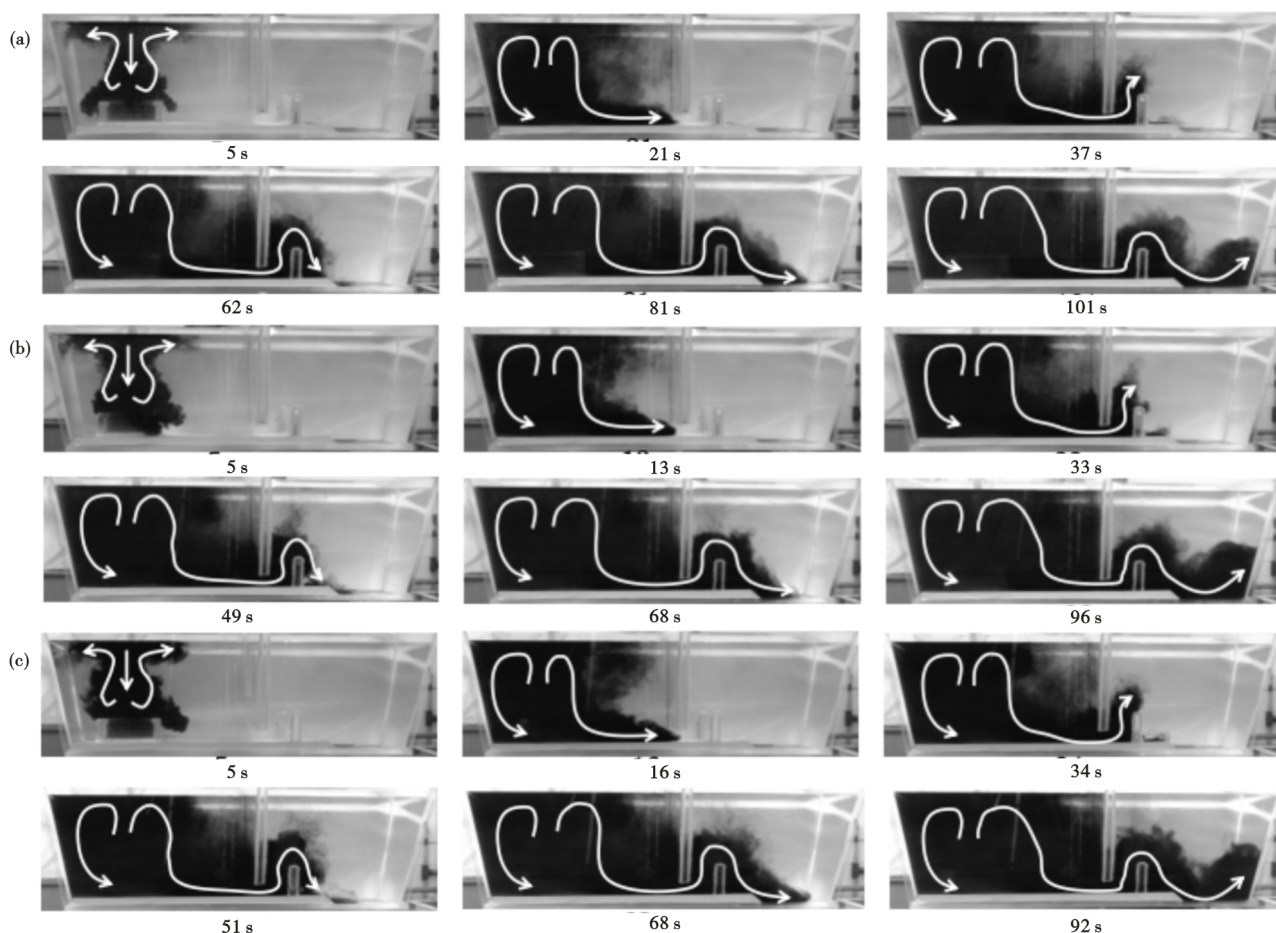
图 3 模型长水口插入深度 75 mm (a), 50 mm (b) 和 25 mm (c) 的流场(流量 1.09 \text{ m}^3/\text{h} )
